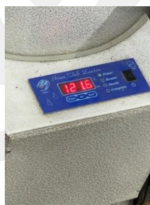
تصویر ۱۹. دماسنج اتوکلاو نشان دهنده دمای ۱۲۰° در طول فرآیند (سری پنجم و ششم)
