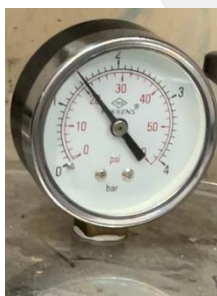
تصویر ۲۰. فشارسنج اتوکلاو نشان دهنده فشار ۲۰psi در طول فرآیند (سری پنجم و ششم)
